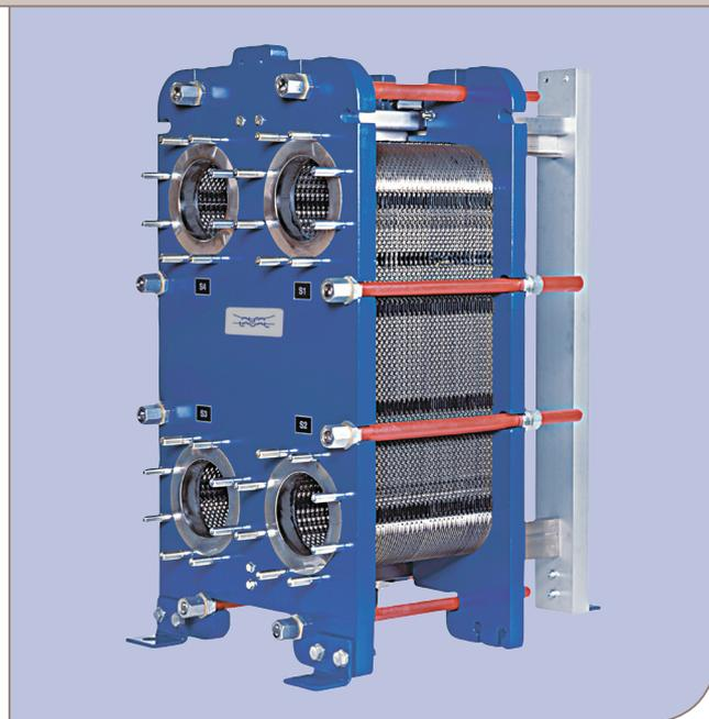
Гофрированная поверхность пластин обеспечивает формирование каналов, высокую турбулентность потока и механическую прочность пакета пластин. Тепло от одной жидкости к другой передается через пластины, а полностью противоточная схема движения теплоносителей позволяет добиться максимальной эффективности теплопередачи.
